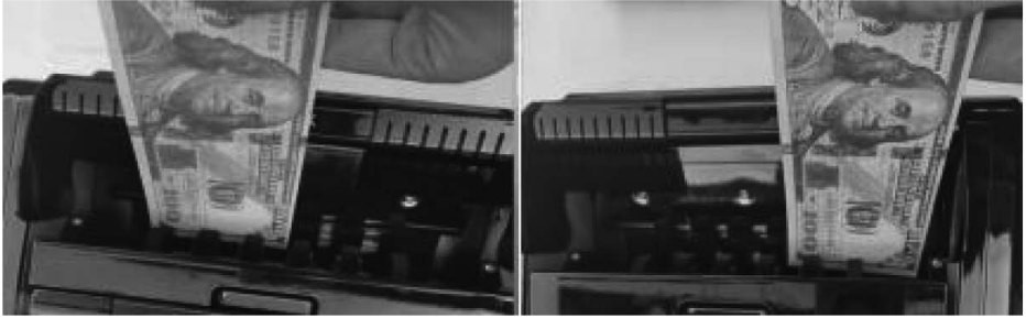
Un billete para comprobar el espacio entre los rodillos
